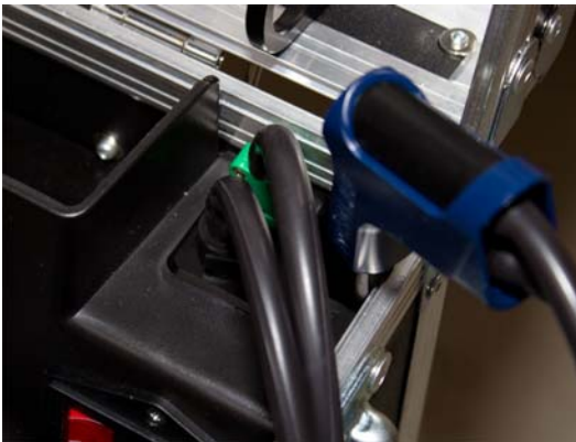
Abb. 61: Anschlüsse der Schlauchkabelsonde zur Zugmessung
