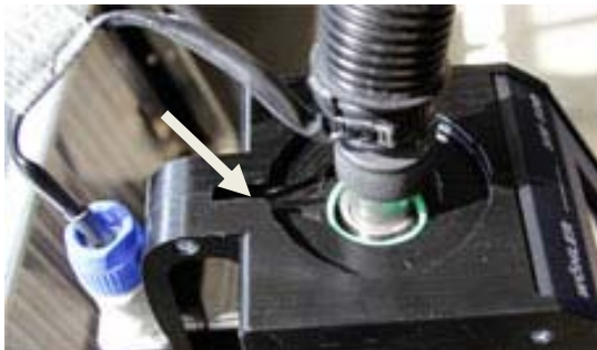
Abb. 79: Einkerbung für Anschlusskabel des beheizten Ansaugschlauches
