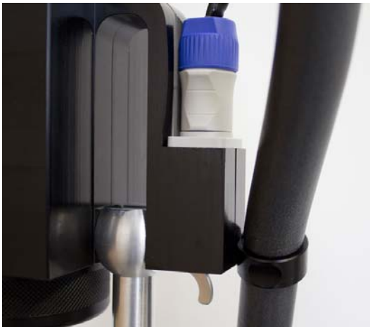
Abb. 14: Fixierung des beheizten Ansaugschlauches am Wiegemodul
