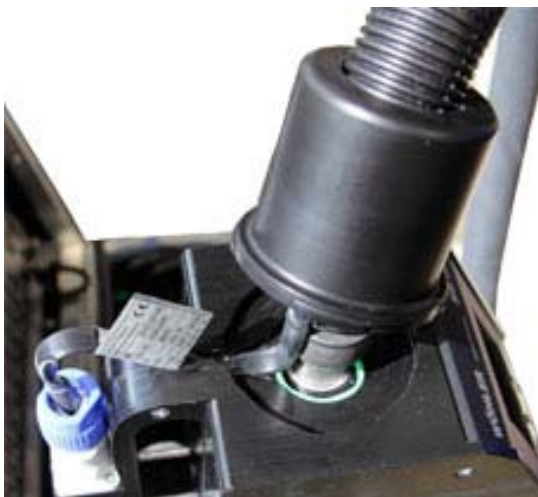
Abb. 80: Anschlusskabel des beheizten Ansaugschlauches ordnungsgemäß verlegt
