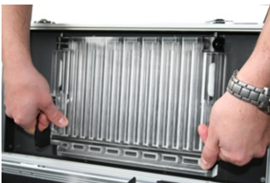
Abb. 64: Ausbau des Abgaskondensators
