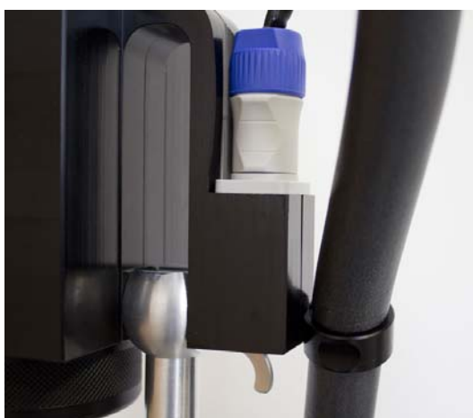
Abb. 6: Fixierung des beheizten Ansaugschlauches
