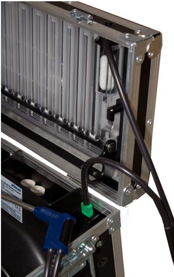
Abb. 34: Anschluss der Schlauchkabelsonde für die Abgasmessung
