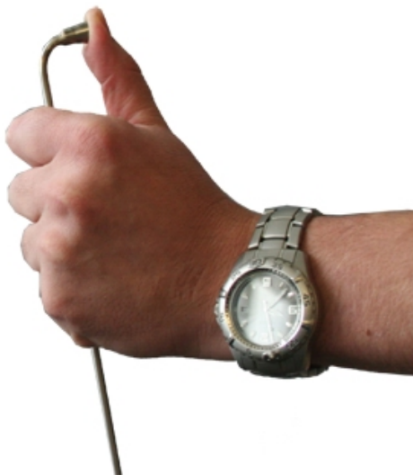
Abb. 18: Abdichten der Sonde
