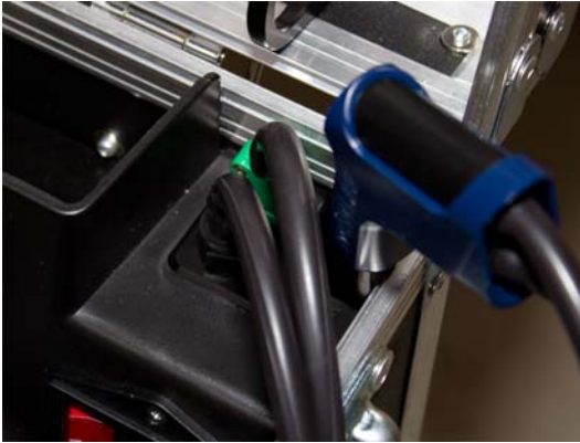
Abb. 10: Anschluss der Schlauchkabelsonde
