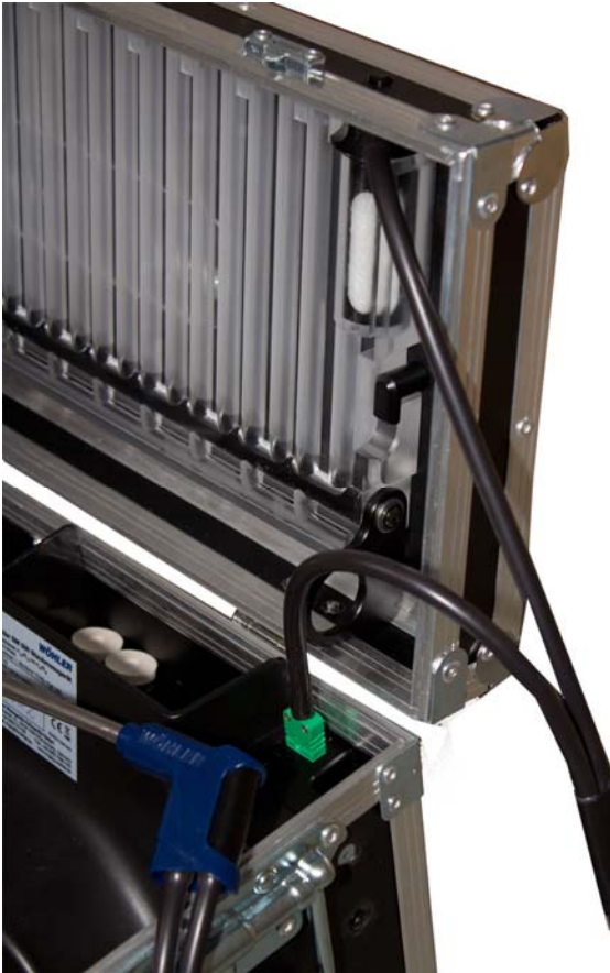
Abb. 57: Anschluss der Schlauchkabelsonde für die Abgasmessung
