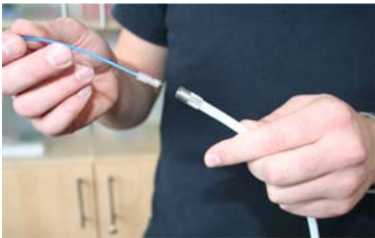
Abb. 68: Reinigung des beheizten Ansaugschlauches
