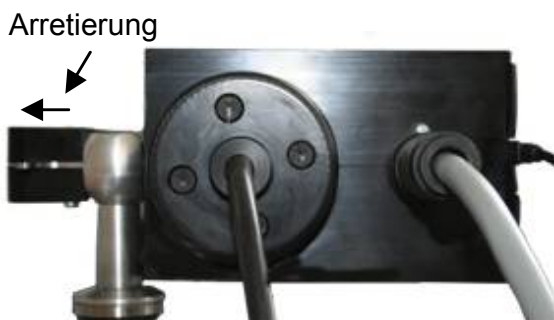
Abb. 5: Arretierung am Wiegemodul lösen
