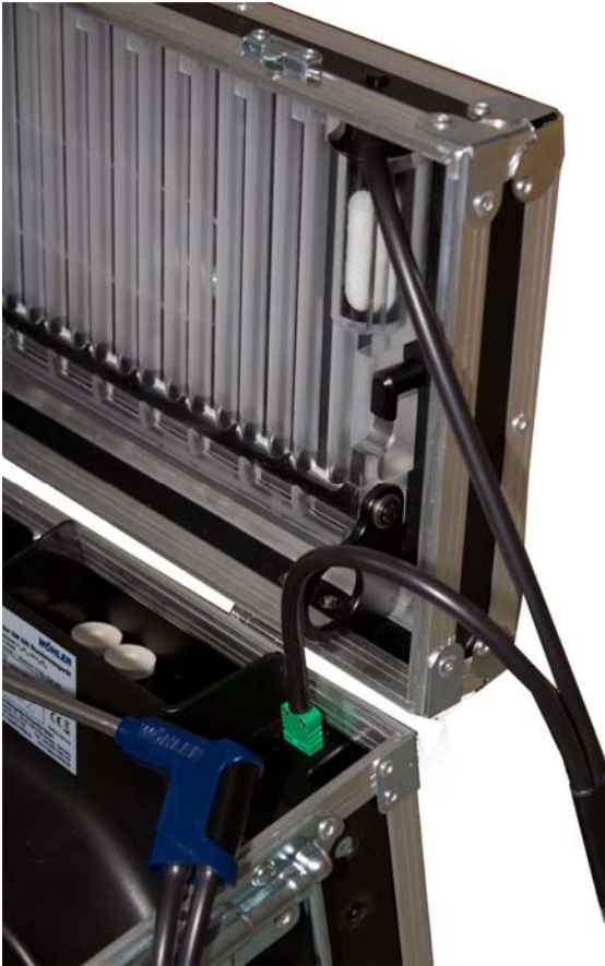
Abb. 11: Anschluss für die Abgasmessung (Sonderfall!)
