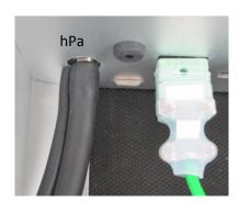
Per effettuare la misura, collegare il tubo della sonda nella presa 'hPa' (vedi illustrazione).
