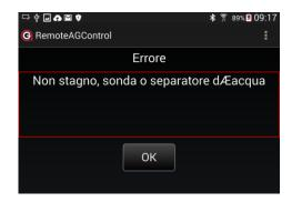
Messaggio in caso di perdite (valore > valore limite). In questo caso controllate il vaso di condensa, le guarnizioni, i vari tubi in silione, guarnizione del filtro primario, triplo filtro, o il tubo della sonda.
