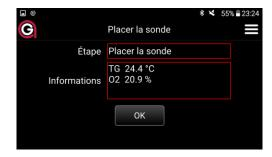
Placer la sonde au milieu du conduit de fumée puis pressez le bouton **OK** pour démarrer la moyenne.
