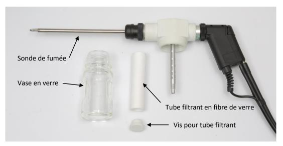
Contrôlez avant chaque mesure, que le tube filtrant ne soit pas bouché.
