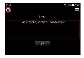
Message affiché en cas de non-étanchéité (valeur > valeur limite). Dans ce cas, recherchez les points de fuite de l'appareil : Joint de la sonde de fumée, joint plat du filtre bois, raccord du filtre en fibre de verre, o-ring du filtre Purafil. Après avoir éliminé l'erreur, pressez **OK** et répétez l'étape précédente.
