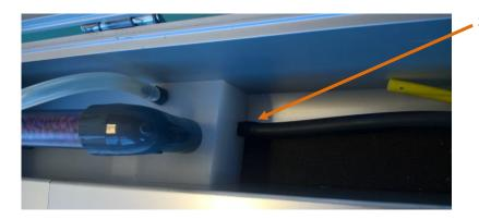
Sonde prélèvement des gaz
