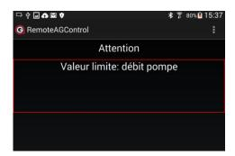
Message affiché si la pression de la pompe est trop faible. Dans ce cas, contrôlez si la sonde ou un autre raccordement de l'appareil n'est pas bouché.
