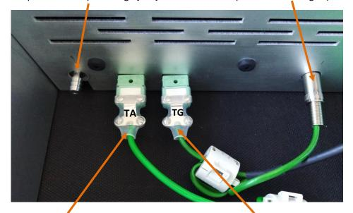
Connexion pour la sonde de température de l'air comburant (TA) Connexion pour la sonde de température des gaz (TG)
