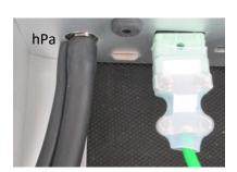
Pour cette mesure le tuyau de la sonde doit être branché sur la connexion 'hPa' de l'analyseur.
