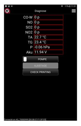
CO-W sensor électrochimique [ppm] (CO < 1200 ppm)
